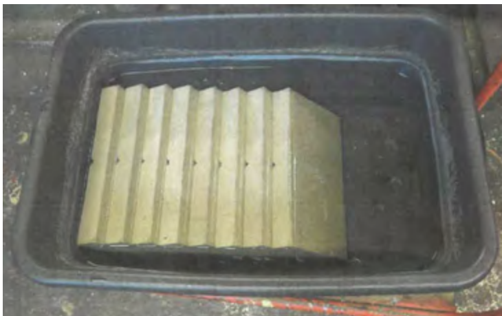
Testowy płyty betonowe nasączone w wodzie jako wilgotne podłoża
